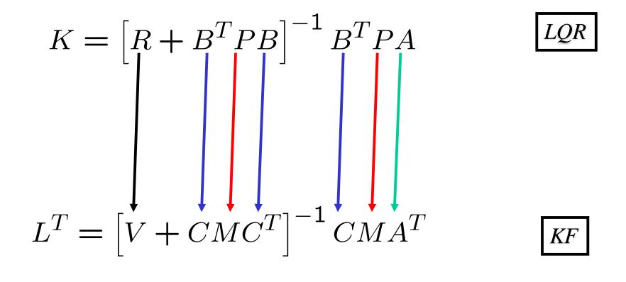
$P \Rightarrow M \quad B \Rightarrow C^T \quad A \Rightarrow A^T \quad R \Rightarrow V$
